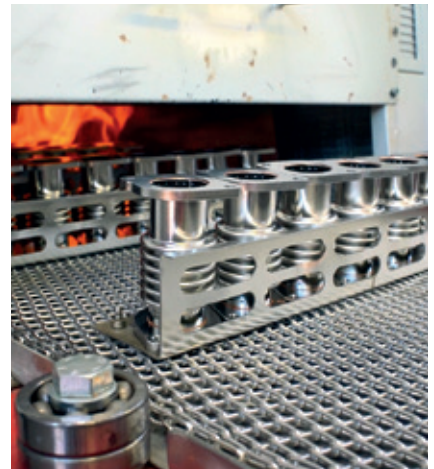
Brasatura a forno, tubazioni acciaio inox
