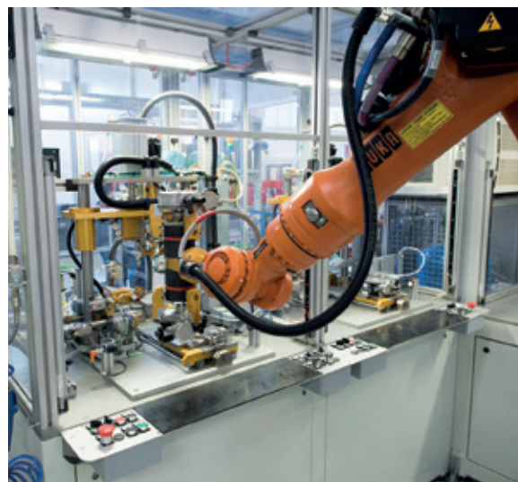
Linea ad alta automazione per l'assemblaggio di regolatori di pressione
