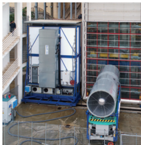
La camera termica realizzata per il Building Future Lab
